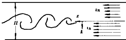
图 1 平面受限混合层计算简图
